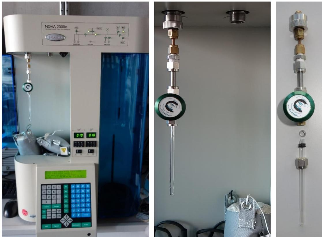
Abb. 17: Sorptionsmanometer Nova 2000e (links) mit angeschlossener Absperrvorrichtung (Mitte) und dessen Aufbau im Detail (rechts).
