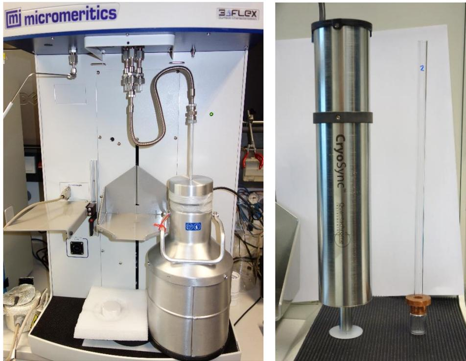
Abb. 15: Apparativer Aufbau zur Argonsorption (links) sowie Kryostat und Messzelle (rechts).
