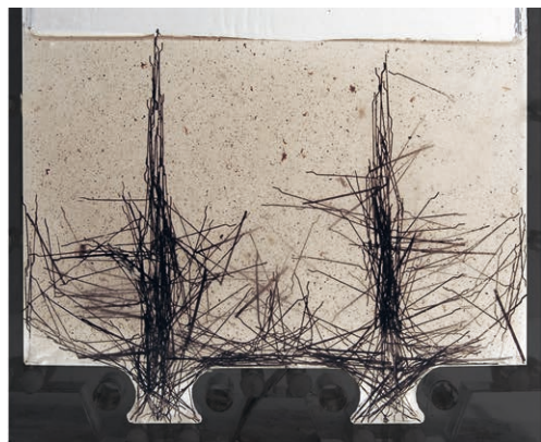
Bild 1: Faseranordnung in einer Zahnverbindung; links: chaotisch, rechts: magnetisch ausgerichtet | Fig. 1: Fibre arrangement in a toothed bond; left: chaotic, right: magnetically aligned | Source: Lukas Ledderose, [4]
