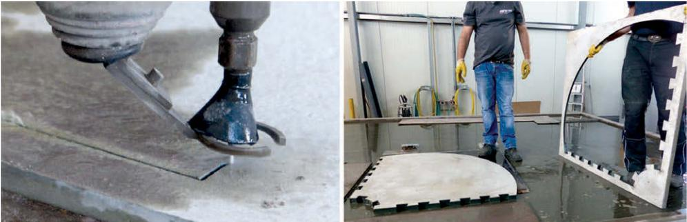
Bild 4: Herstellung der Plattenelemente | Fig. 4: Manufacturing of slab elements | Source: Lukas Ledderose
