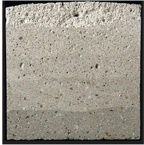
**Bild 3:** Aufschwimmen des Leichtbetons innerhalb des im Nassspritzverfahren hergestellten Probekörpers (links) und diskrete Schichtgrenzen des im Trockenspritzverfahren hergestellten Probekörpers (rechts) | **Fig. 3:** Floating of the lightweight concrete within the test specimen produced by wet spraying (left) and discrete layers of the test specimen produced by dry spraying (right)
