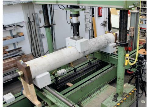
Bild 22: Versuchsaufbau für die Biege- und Querkraftversuche an dünnwandigen Betonhohlbauteilen und Messtechnik | Fig. 22: Test setup for bending and shear tests on thin-walled hollow concrete members and measurement
