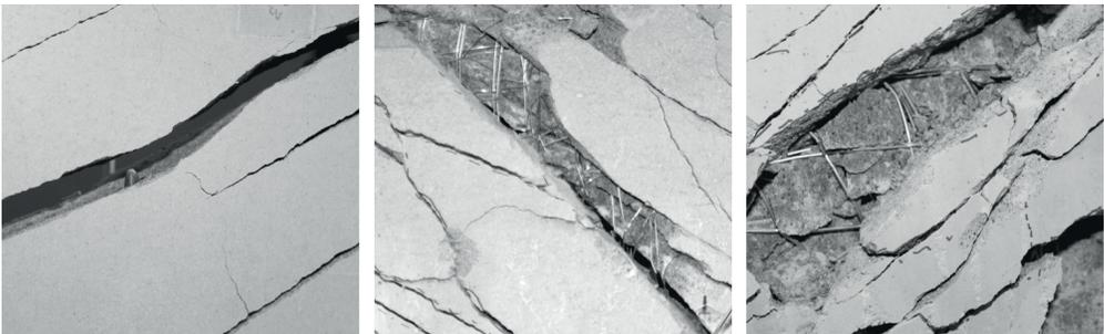
Bild 20: Versagensbilder der Versuchskörper Q0 (Stegzugversagen B500, links), Q1 (Stegzugversagen Mikrobewehrung, Mitte) und Q3 (sekundäres Betonversagen, rechts) | Fig. 20: Failure characteristics of specimens Q0 (tensile failure of B500, left), Q1 (tensile failure of micro-reinforcement, middle) and Q3 (secondary concrete failure, right)
