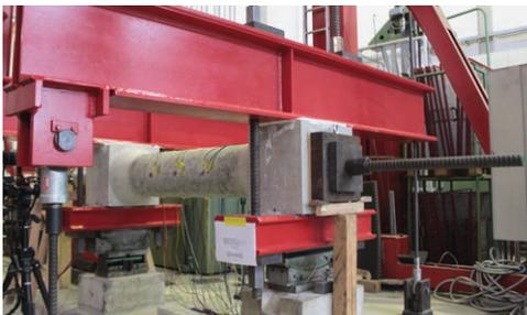
**Bild 27:** Versuchsaufbau für die Torsionsversuche an dünnwandigen Betonhohlbauteilen und Messtechnik | **Fig. 27:** Test setup for torsional tests on thin-walled hollow concrete members and measurement
