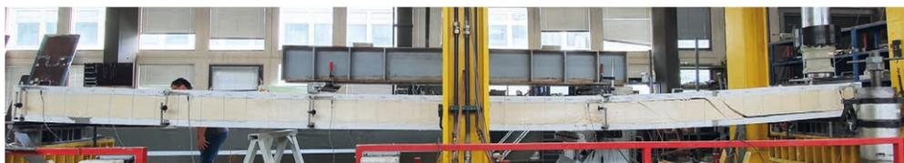
**Bild 3:** Versagen eines Versuchskörpers im Vier-Punkt-Biegeversuch | **Fig. 3:** Failure of a test specimen in a four-point bending test | © IMB der RWTH Aachen
