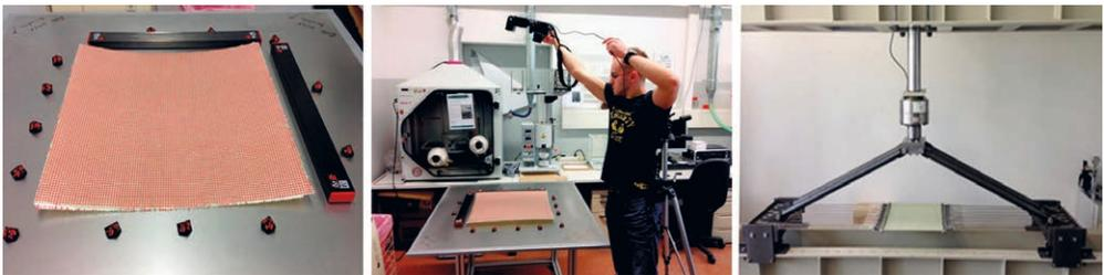
Bild 3: Gekrümmte GFRP-Schichtverbundplatte mit codierten Messmarken (links), Versuchsaufbau im Formänderungsanalysesystem ARGUS (Mitte) und ABD-Strukturprüfstand (rechts) | Fig. 3: Curved GFRP composite plate with coded reference mark (left), test set-up for optical shape change analysis with the system ARGUS (middle) and ABD-test bench (right)
