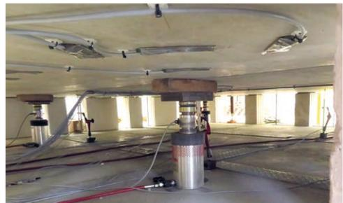
**Bild 15:** Belastungs- und Messtechnik je Hälfte | **Fig. 15:** Load and measurement technology per half
