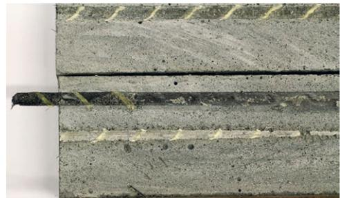
Bild 4: Aufgeschnittener Versuchskörper nach Spannkrafteinleitungsversuch | Fig. 4: Sliced specimen after transfer length test
