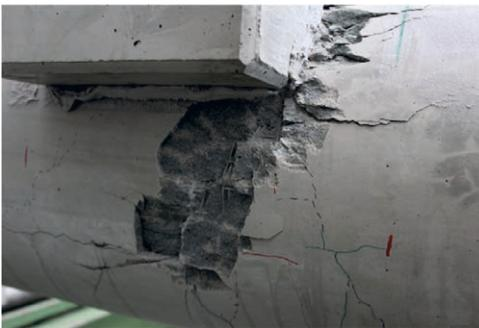
Bild 25: Versagensmodus des Versuchskörpers KR4 (Biegedruckversagen) | Fig. 25: Failure characteristics of specimen KR4 (failure of concrete in compression)
