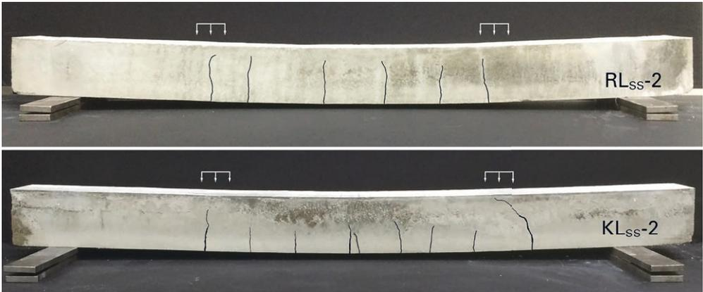
**Bild 14:** Abgeschlossene Rissverteilung zweier stahlbewehrter Probekörper, Versuchsserien RL<sub>SS</sub> und KL<sub>SS</sub> | **Fig. 14:** Final crack distribution of a steel reinforced test specimen for the series RL<sub>SS</sub> and KL<sub>SS</sub>
