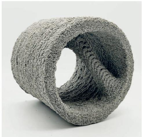
**Bild 14:** Innen verstrebtetes Rohr, hergestellt durch *Selective Cement Paste Intrusion* | **Fig. 14:** Pipe with internal structures manufactured by *Selective Cement Paste Intrusion*
