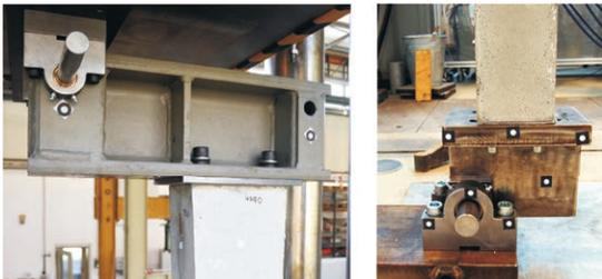
Bild 11: Versuchsprogramm für exzentrisch gedrückte Stützen zur Überprüfung der Ergebnisse der Formfindung für zwei unterschiedliche Moment-Normalkraft-Verhältnisse; mittlere Stützenabmessungen und Lasteinleitungskonstruktionen | Fig. 11: Test program for non-axial loaded columns for verification of the optimization results for two different load ratios of bending moment and normal force, average dimensions of the columns and lever arm constructions
