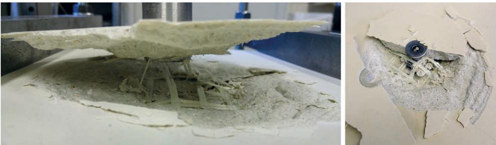
Bild 12: Preform-Probe nach Auszugversuch in 0°-Richtung | Fig. 12: Preform specimen after pull-out test in 0° direction
