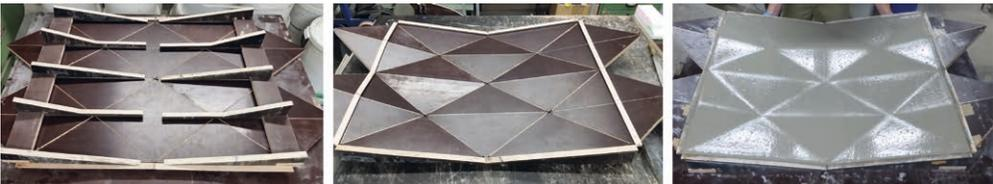
**Bild 18:** Herstellung eines Elementes für die segmentierte Tonnenschale mit dem Fold-in-fresh-Verfahren; v. l. n. r.: Bestandteile der faltbaren Schalung, Schalung im gefalteten Zustand, Betonelement kurz nach dem Falten | **Fig. 18:** Production of a folded segment for the segmented barrel vault by fold-in-fresh; from left to right: components of foldable formwork, formwork in folded condition, folded element shortly after folding
