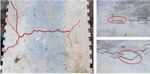
**Bild 23:** Rissbild in der zentralen Platte (links) und Lösen der Zahnleistenverbindung (rechts) | **Fig. 23:** Crack pattern in the central plate (left) and loosening of the dry joints (right)
