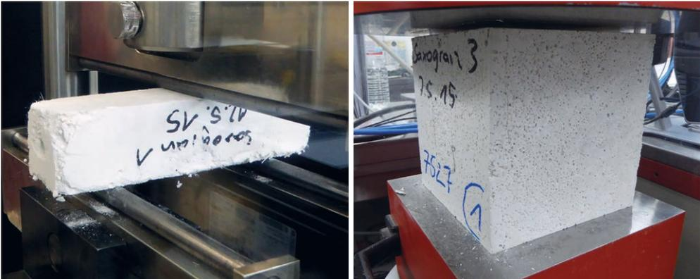
Bild 1: Ermittlung von Biegezug- und Druckfestigkeit | Fig. 1: Determination of bending tensile and compressive strength
