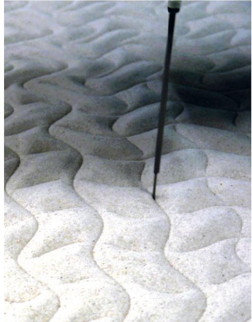
**Bild 11:** CNC-gesteuerte Nadel während der Injektion von Wasser in trockenen Sand | **Fig. 11:** CNC-controlled needle injecting water into dry sand
