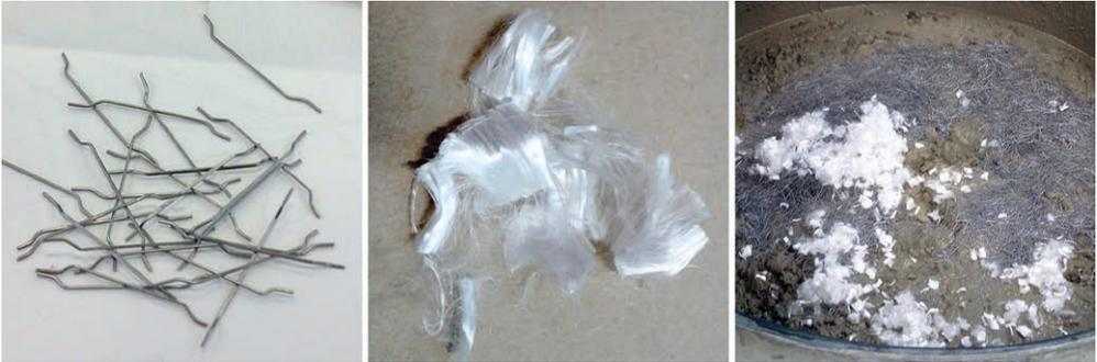
**Bild 6:** Verwendete Kurzfasern; von links nach rechts: Stahlfasern DE25/0, PP-Fasern PM 12/18, Fasercocktail | **Fig. 6:** Used short fibres; from left to right: steel fibres DE25/0, PP fibres PM 12/18, fibre cocktail
