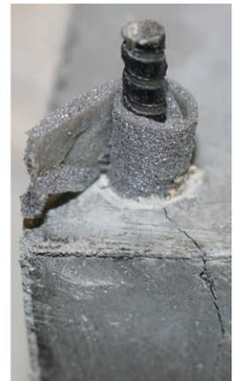
**Bild 2:** Exemplarische Verbundspannungs-Schlupf-Kurven je Stabart bei  $l_b^* = 3$  und  $c^* = 2$  (REBAR Ø6-B zusätzlich  $l_b^* = 3$  und  $c^* = 3$ ) (links); Rissbildung bei REBAR Ø6-B,  $c^* = 2$  (rechts) | **Fig. 2:** Exemplary bond stress-slip curves for each bar type with  $l_b^* = 3$  and  $c^* = 2$  (REBAR Ø6-B also  $l_b^* = 3$  and  $c^* = 3$ ) (left); crack formation for REBAR Ø6-B,  $c^* = 2$  (right)
