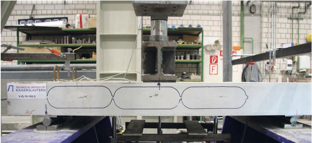
Bild 23: Versuchsaufbau am Beispiel V-Q-10-160-2 | Fig. 23: Test setup using the example of V-Q-10-160-2
