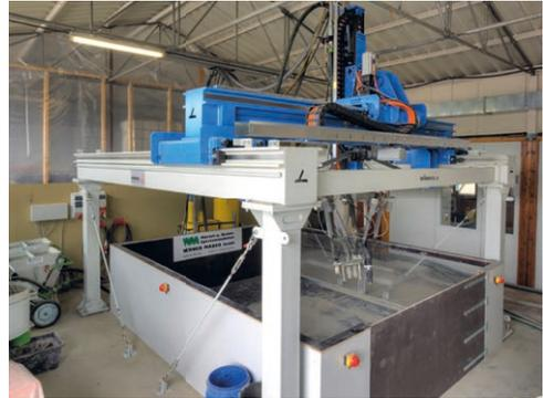
Bild 6: Realisierte Herstellungsplattform | Fig. 6: Realized production system
