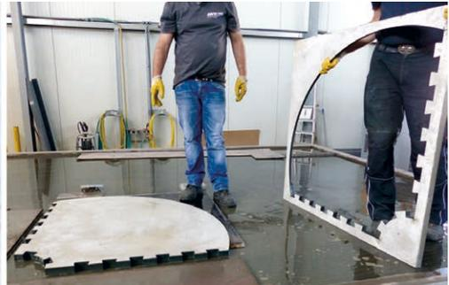
**Bild 4:** Herstellung der Plattenelemente | **Fig. 4:** Manufacturing of slab elements | Source: Lukas Ledderose
