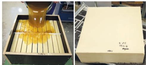
**Bild 2:** Vergießen von Kaltwachs-Tabletten mit Heißwachs zu Wachsböcken (links), abgekühlter Wachsböck (rechts) | **Fig. 2:** Grouting of cold wax tablets with hot wax to wax blocks (left), cooled off wax block (right)
