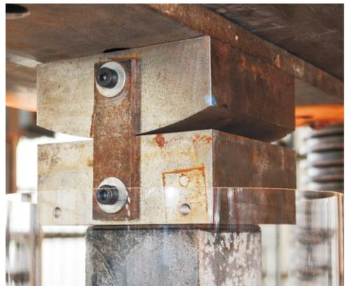
Bild 5: Gelenkiges Linienlager | Fig. 5: Hinged line support
