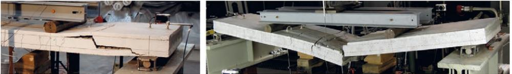
**Bild 5:** Geschichtete Platten aus Normal- und Porenleichtbeton (C20/25-PLB) mit Fugenversagen (links) bzw. Biegezugversagen (rechts) | **Fig. 5:** Layered slabs made of regular and foam concrete (C20/25-PLB) with interface failure (left) and bending failure (right)
