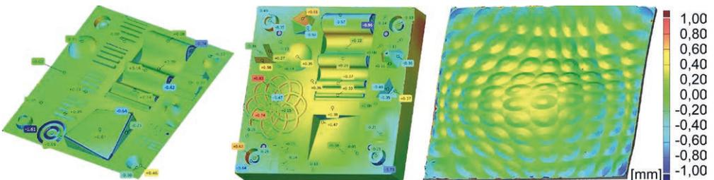
**Bild 19:** Flächenvergleich zwischen Scandaten der hergestellten UHPC-Abgüsse und CAD-Datensätzen | **Fig. 19:** Surface comparison between the scan data of the UHPC casts and the original CAD data
