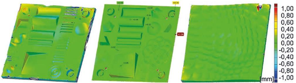
**Bild 18:** Vergleich zwischen Scandaten der CFW-Wachsblöcke A–C vor und nach dem Abguss mit UHPC | **Fig. 18:** Comparison between the scan data of the CFW wax blocks A–C before and after the UHPC cast
