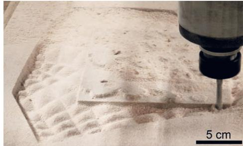
**Bild 4:** Schalungsgeometrie während des Schlichtgangs der formgebenden Bearbeitung | **Fig. 4:** Formwork geometry during finishing step of the milling process
