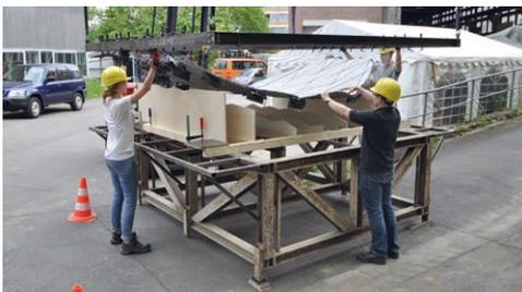
Bild 17: Canopy-Faltragwerk: Faltprozess durch Hängen (links); Ansicht fertige Schale (rechts) | Fig. 17: Canopy shell: folding process by hanging (left); view of finished structure (right)
