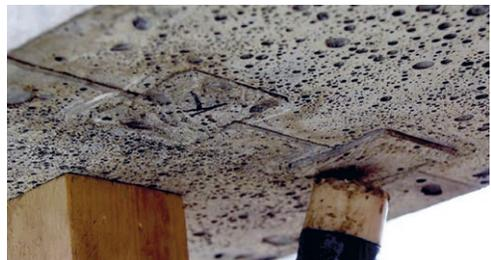
Bild 11: Fügung mit UHPFRC-Passstücken auf der Unterseite des Plattenbalkens in der Zugzone | Fig. 11: Joining with UHPFRC inlays under the T-beam in the tension zone
