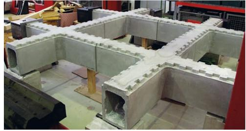
**Bild 21:** Prüfung des Gitterrostes; links: während des Aufbaus und rechts fertiger Prüfaufbau | **Fig. 21:** Test of the coffered ceiling; during construction (left) and finished test set-up (right)
