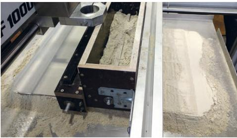
**Bild 3:** Dispenser für die Herstellung der Materialschicht; rechts: frisch aufgetragenes Material, links: geglättete und verdichtete Schicht | **Fig. 3:** Dispenser for creating dry material layers; right: freshly dispensed material, left: smoothed and compacted layer
