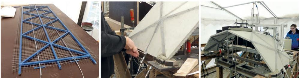
**Bild 21:** Vorgespannter gefalteter Bogen; v. l. n. r.: Faltmuster mit eingebauten Spanngliedern, Aufbringung der Vorspannung und experimentelle Untersuchung | **Fig. 21:** Prestressed folded vault; from left to right: crease pattern with installed tendons, applying the pre-stressing, testing of a vault
