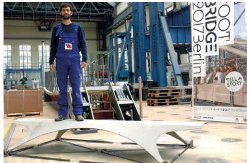
Bild 11: Carbonbeton-Schalendemonstrator mit Regelflächengeometrie, gezeigt auf der Footbridge 2017 Conference | Fig. 11: Carbon reinforced concrete shell bridge with ruled surface geometry, exhibited at the Footbridge 2017 Conference
