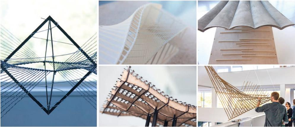
Bild 18: Objekte mit Regelflächengeometrie, entstanden bei der LGLS-Sommerschule 2018 in Dresden | Fig. 18: Objects with ruled surface geometry, created at the LGLS Summer School 2018 in Dresden
