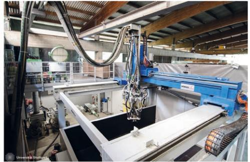
**Bild 8:** Gesamtkonzept und Realisierung der Plattform zur Herstellung funktional gradierter Betonbauteile | **Fig. 8:** Concept and realization of the whole manufacturing system to produce graded concrete components
