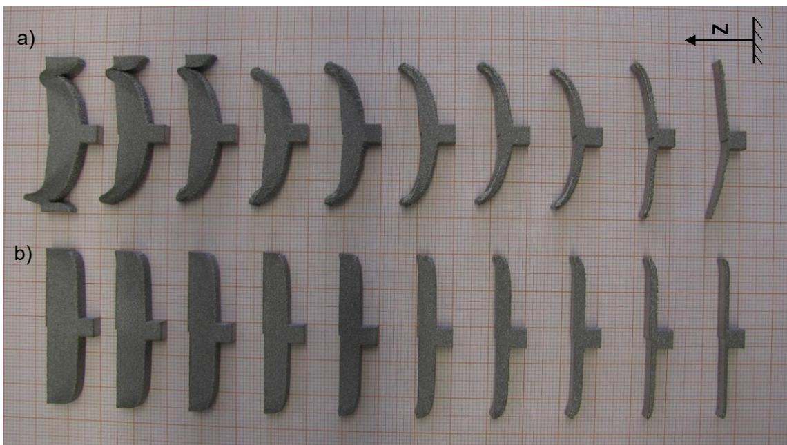
Abbildung 44 Formabweichungen der Demonstratoren mit Downskin-Winkel a)  $\delta = 5^\circ$  und b)  $\delta = 0^\circ$  zur Untersuchung der kritischen Überhanglänge
