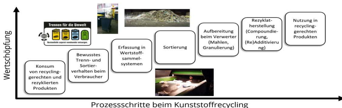
Abbildung 11 Prozesse bei der Rückführung von Kunststoffabfällen angelehnt an Böttcher (2015), Bilder: [www.netto.de](http://www.netto.de), Maletz
