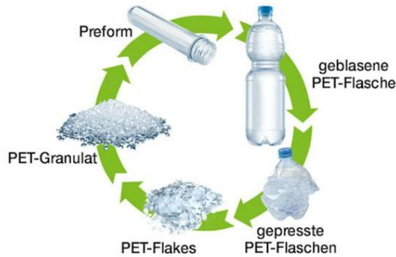
Abbildung 25 Kreislauf des PET-Flaschenrecyclings (Bild: Ensinger GmbH)
