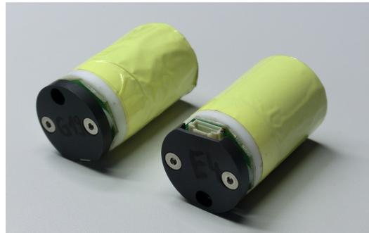
Abbildung 4.7: Foto der Induktionsspulen: gradiometrische Spule und Einfachspule
