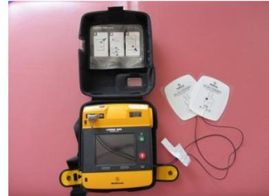
**Abbildung 5: AED "Lifepak 1000" mit originalen "Softpaddle"-Elektroden**
