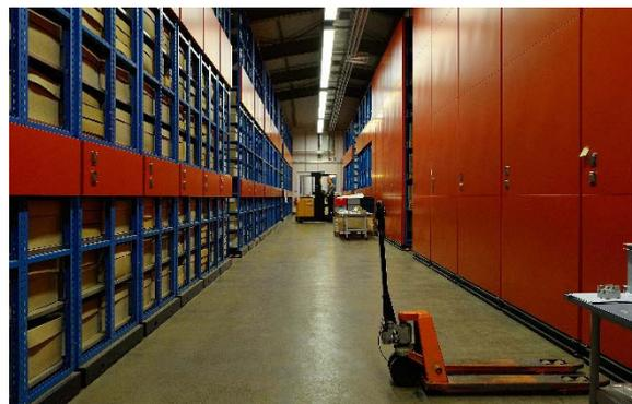
Abb. 3: Fahrregale für Normkartons und Europaletten (geschlossener Bereich rechts) in Halle 1. © LfA Sachsen. Aufnahme: Guido Tom Kahle.
