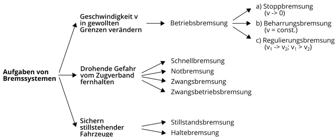
**Abb. 3: Übersicht über verschiedene Bremsarten nach [JAE16a]**
