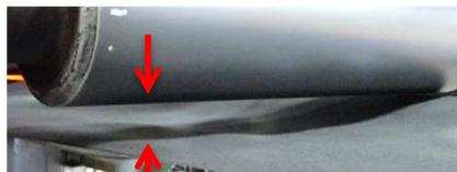
**Abbildung 8-12: vollflächige Bahndeformation als fortgepflanztes Fehlerbild, Markierung des einseitigen Durchhängens mit roten Pfeilen**
