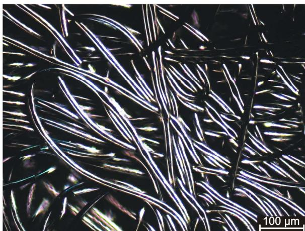
**Abbildung 9-4: Mikroskopieaufnahme eines dickenkalibrierten GDL-Basisvliesstoffes, mit Verformungen von Einzelfasern an Kreuzungspunkten**
