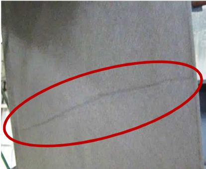
**Abbildung 4-16: Fehlerbild Queraufrauung (rot markiert)**
