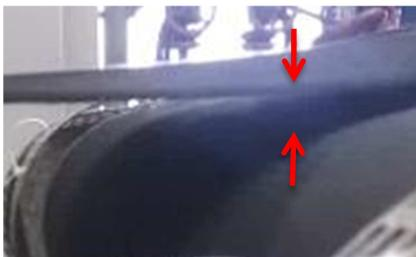
**Abbildung 8-11: vollflächige Bahndeformation in der GDL-Basisvliesstoffherstellung, Markierung des einseitigen Durchhängens mit roten Pfeilen**
