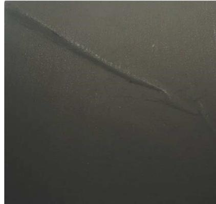
**Abbildung 4-2: prozessbeeinträchtigender Fehler, Staufalte führt zum Materialstau an Walzenspalten**
