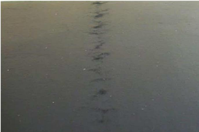
**Abbildung 4-3: Brennstoffzellen-Membran-schädigender Fehler mit rauher Oberfläche**
