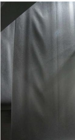
**Abbildung 4-13: Fehlerbild kurze Diagonalverzüge**
