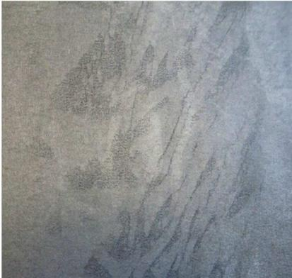
**Abbildung 4-1: optischer Fehler, Beschichtung durchdringt GDL-Substrat**
