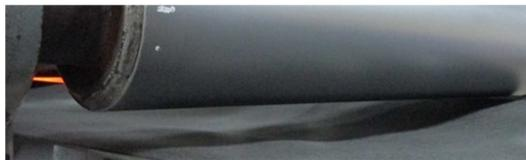
**Abbildung 4-14: vollflächige Bahndeformation[24]**
