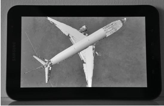
*Abbildung 7: Incremental-Impostor-Streaming-Client auf einem Samsung GalaxyTab: Darstellung des 3D-Modells eines Verkehrsflugzeugs vom Typ Boeing 777 (ca. 350 Millionen Dreiecke, Quell-3D-Daten zur Verfügung gestellt von The Boeing Company)*
