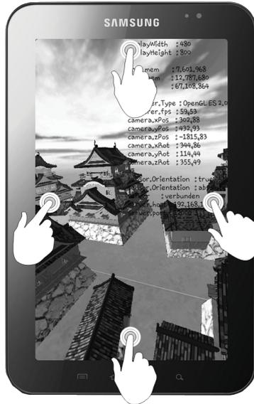
Abbildung 9 (Mitte): Bewegung der virtuellen Kamera nach links, rechts, oben und unten durch Berühren des Touchscreens
