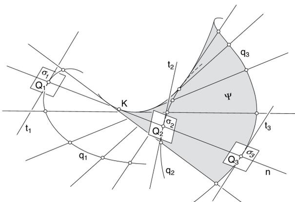
Bild 2: Festlegung einer Regelfläche durch die Treffgeraden zu drei Kurven  $q_1$ ,  $q_2$  und  $q_3$ , aus LORDICK [11]
