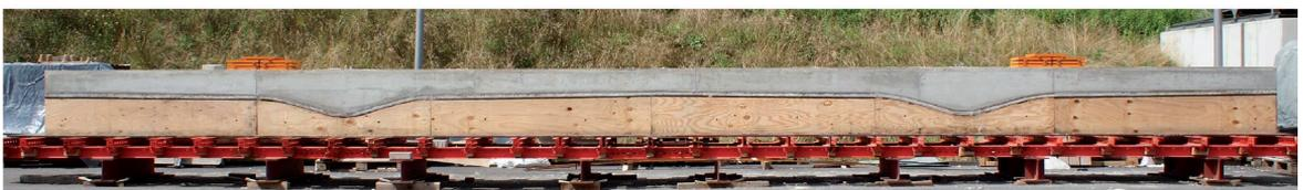
Bild 14: Herstellung eines formoptimierten geschichteten Deckenstreifens: Betonage der untersten und mittleren Schicht, während des Transportes und fertiger Träger [Fotos: Michael Frenzel]
