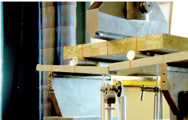
Bild 19: Versuchsaufbau Biegezugprüfung [8]
