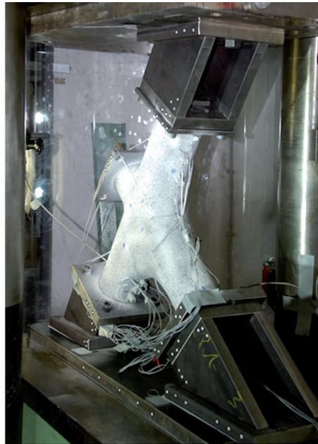
Bild 10: Versuchsaufbau für die Knotenprüfung [5]
