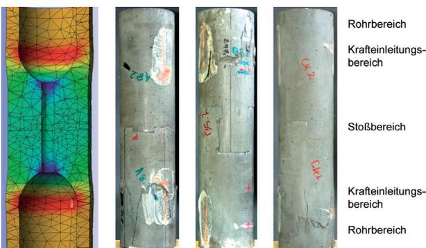
Bild 6: Versuche an Trockenstoßverbindungen: berechneter Schubkraftverlauf (hier für Serie A8, die roten Bereiche sind am stärksten, die blauen am schwächsten ausgelastet) und gefügte Probekörper nach dem Druckversuch: Serie A8, B5 und C4 (von links nach rechts) [Quelle: iBMB]
