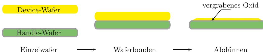
**Abbildung 5.5:** Vereinfachter Herstellungsprozess und Prinzipaufbau eines BSOI-Wafers. Durch das Verbinden von zwei Wafern und die Möglichkeit Waferschichten nach dem Waferbonden abzdünnen, sind BSOI-Wafer sehr flexibel herstellbar und weisen eine vergrabene Oxidschicht (BOX) auf. Diese kann in der weiteren Prozessfolge beispielsweise als selektiver Ätzstopp und als elektrische Isolationsschicht genutzt werden.
