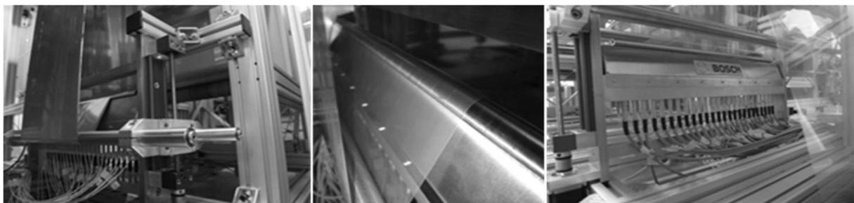
**Abbildung 9:** FriWFP-Scanner im Bahnlaufversuchsstand des Fraunhofer IVV Dresden [19]
