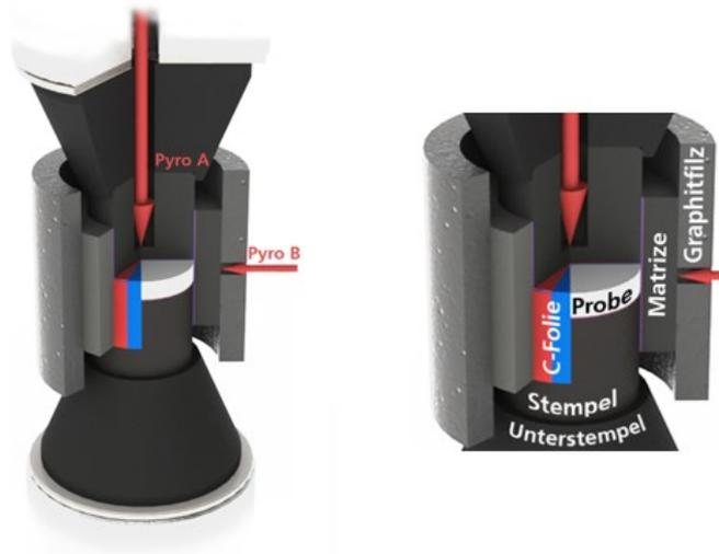
Abbildung 3.2: Schematische Darstellung des verwendeten Werkzeugaufbaus zur Materialverdichtung mittels FAST/SPS. [Quelle: Fraunhofer IKTS, Jan Räthel, bisher unveröffentlicht]
