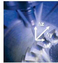
Die ermittelten TCP-Verlagerungen werden in die Maschinensteuerung transferiert und dort über die Anpassung der Fahrbefehle korrigiert.
