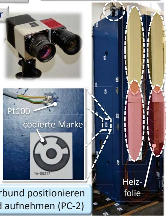
**Ablauf thermograf. Messung:** Kameraverbund positionieren
