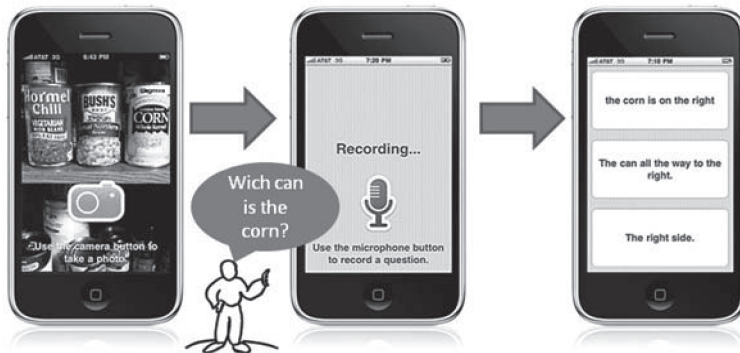
Abbildung 2: die VizWiz Smartphone App arbeitet in drei Schritten: ein sehbehinderter Nutzer macht ein Foto und nimmt eine Frage auf; beides wird an die Crowd gesandt, die die Antwort direkt zurück auf das Smartphone sendet; Quelle: [1]
