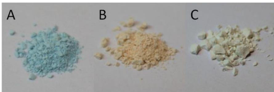
**Abbildung 28:** Das ursprünglich weiße UiO-67(bipy) wird Blau nach Beladen mit Kupfersalzen (A), Orange nach Beladen mit Kobaltsalzen (B) und Hellgrün nach Beladen mit Nickelsalzen (C).
