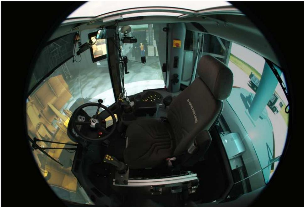
Abbildung 2.15: Fahrsimulator mit der Kabine einer mobilen Arbeitsmaschine
