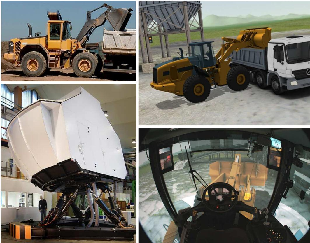
Abbildung 1.3: Interaktiver Simulator mit der Fahrsimulation eines Radladers
