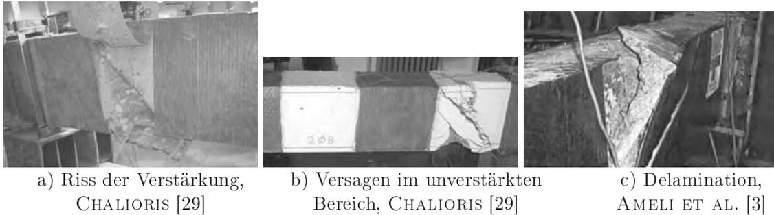
Bild 2.32: Versagen der torsionsverstärkten Probekörper
