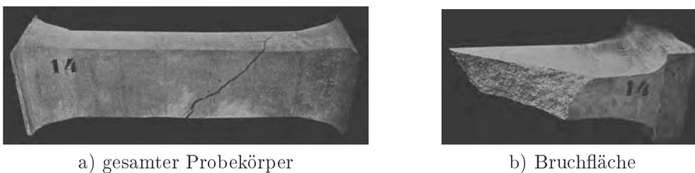
Bild 2.24: Bruchfläche eines unbewehrten Betonkörpers mit rechteckigem Querschnitt, BACH/GRAF [8]
