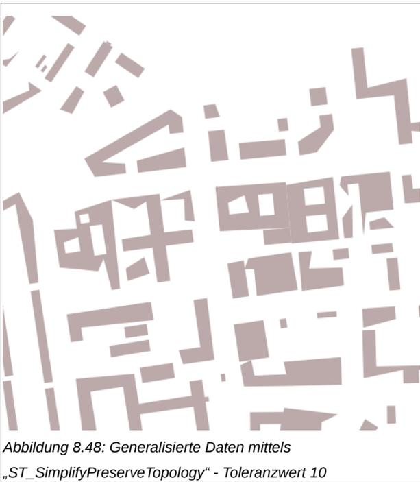
Abbildung 8.48: Generalisierte Daten mittels „ST\_SimplifyPreserveTopology“ - Toleranzwert 10
