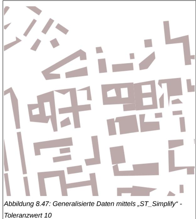
Abbildung 8.47: Generalisierte Daten mittels „ST\_Simplify“ - Toleranzwert 10
