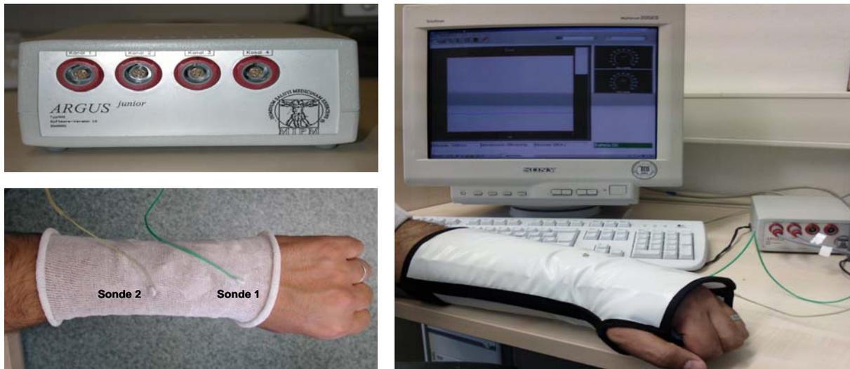
Abb. 7.2: Messung des Druckes der Schiene auf der Haut - Messgerät (links oben), Drucksensoranordnung (links unten), Arm des Probanden und Messtechnik während der Messung (rechts)
