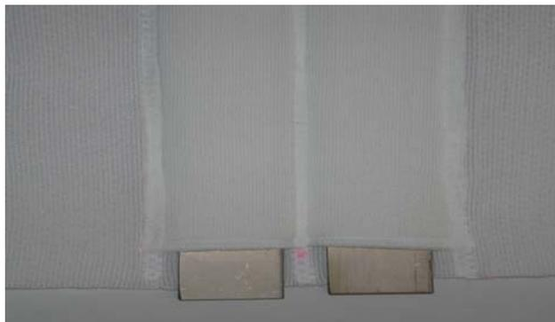
Abb. 6.5: zusätzliche Lagestabilisierung mittels Metallschienen
