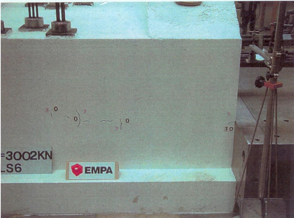
Abb.7.B.32 Laststufe 6 (7);  $P = 3002 \text{ KN}$ , Frontansicht: unverändertes Rissbild
