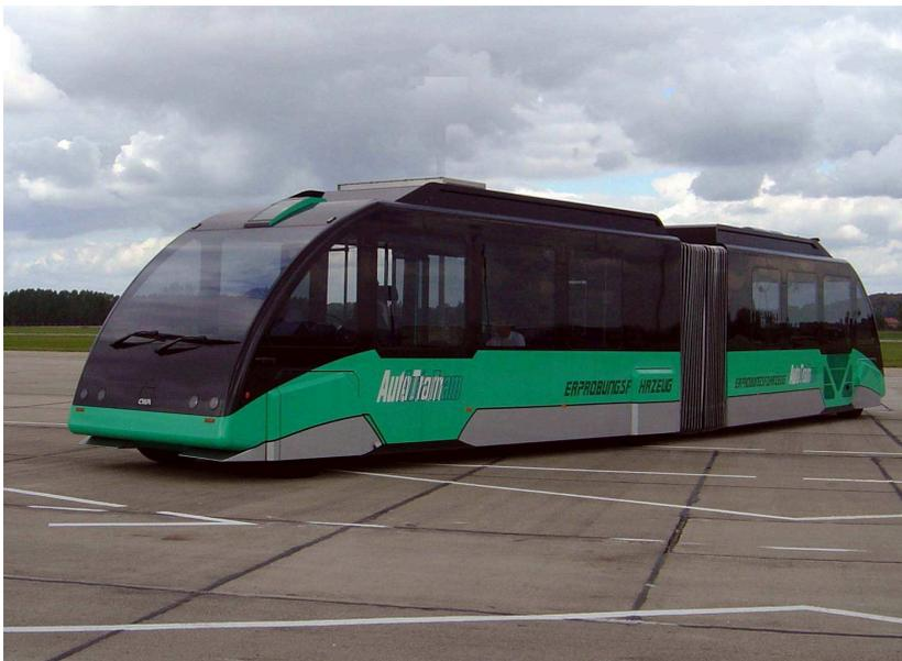
**Bild 4.13:** Das zweigliedrige, allrad-gelenkte Versuchsfahrzeug AutoTram
