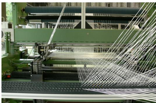
c) Zuführung der hinteren Kettfadenlage
