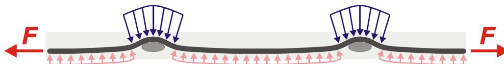
**Bild 72:** schematische Darstellung der durch die Kettfadenauslenkung hervorgerufenen Querkzugkräfte [281]
