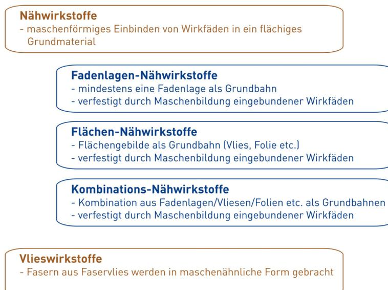
**Bild 3: Einteilung der auf Näh- und Vlieswirkmaschinen hergestellten Flächengebilde (vergl. [207])**
