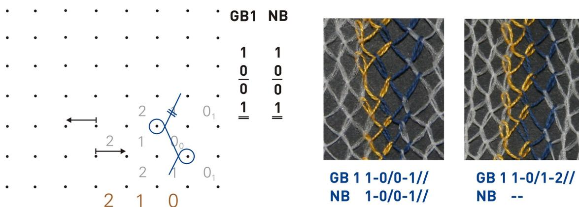
Bild 21: Legungsbild *vrP*(links) und Vergleich mit Äquivalenzbindung (rechts): RL-Franse, offen mit gleichgerichtetem Basisversatz 1
