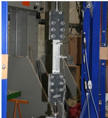
**Bild 66: Zugversuch am Dehnkörper**
