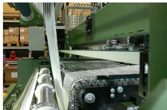
d) Zuführung der Kett- und Schussfadenlagen
