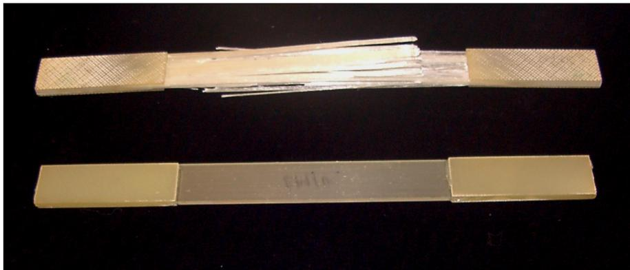
Abb. 48: Prüfkörper (unidirektionaler Verbundwerkstoff) mit unterschiedlich geschichteten Glasfasern in axialer Richtung für statische und dynamische Untersuchung. (Oben) nach der Messung, (unten) Anfangsstadium
