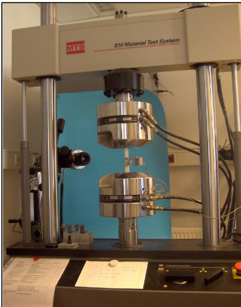
Abb. 50: Servohydraulische Prüfmaschine 810 MTS für dynamische Zugversuche am Institut für Polymerforschung Dresden e.V.
