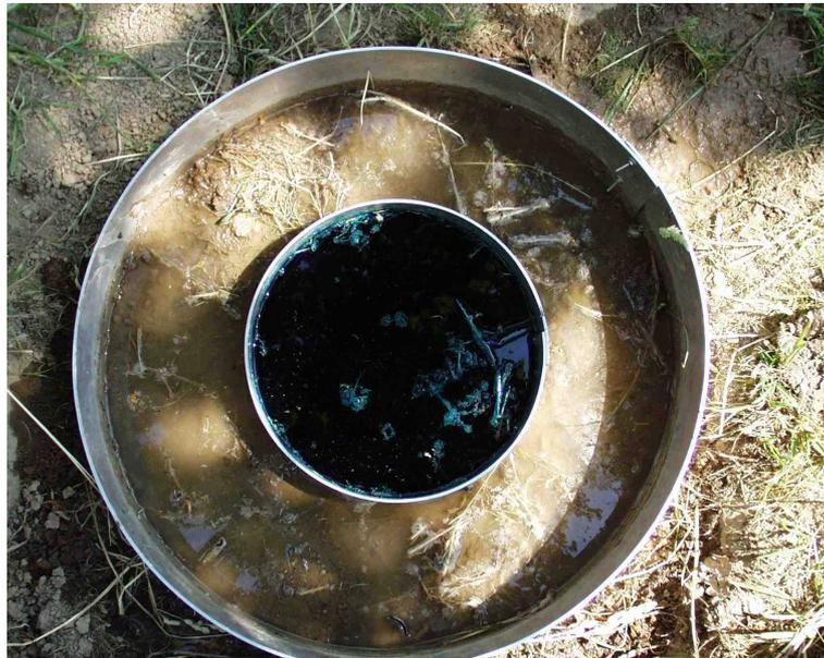
Abbildung 5.12.: Farbtracer im Innenring des Doppelringinfiltrometers
