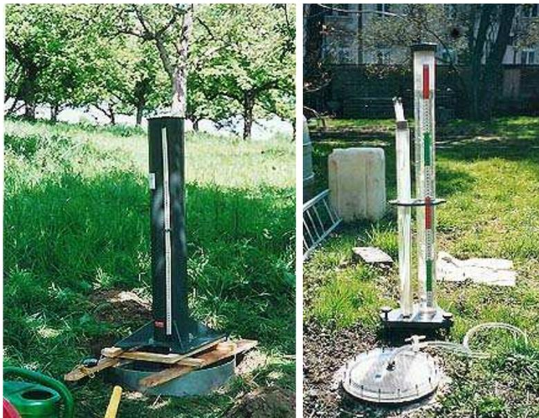
Abbildung 5.8.: Doppelring- und Tensionsinfiltrometer
