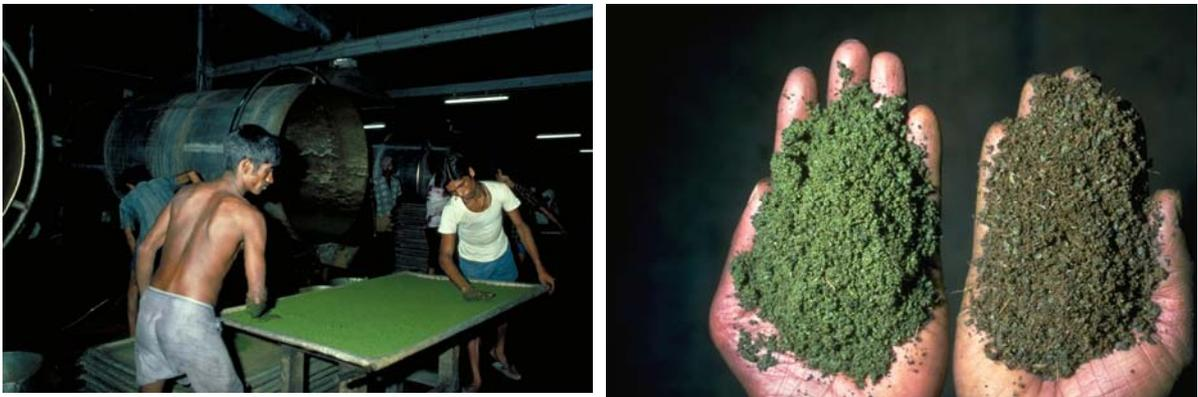
**Abbildung 7: Fermentieren in einer Teefabrik (links) und Tee vor und nach Fermentation (rechts), (Quelle: Deutscher Teeverband e.V.)**
