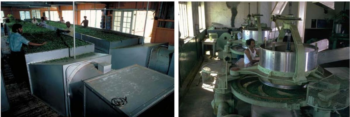
**Abbildung 6: Welken und Rollen in einer Teefabrik, (Quelle: Deutscher Teeverband e.V.)**
