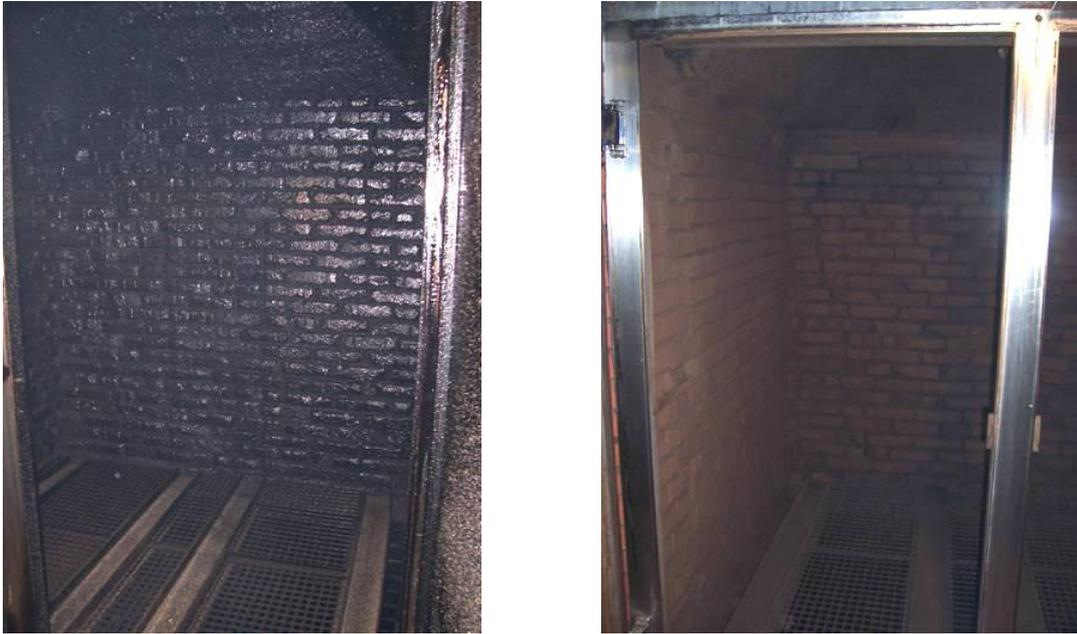
**Abbildung 38: Räucherammer des Kaminräucherverfahrens vor der Reinigung (links) und nach der Reinigung (rechts)**
