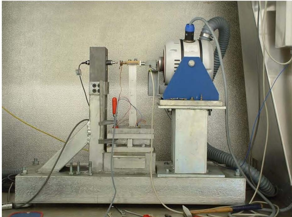
Abbildung 3.15: Darstellung einer möglichen Prüfeinrichtung für den 2-Punkt-Biegeversuch
