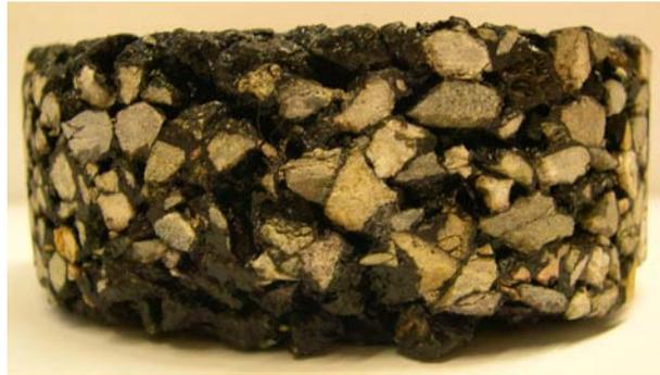
Abbildung 6.1: Probekörper des OPA 0/8 mit einer Höhe von 4 cm und deutlichen Kantenabbrüchen
