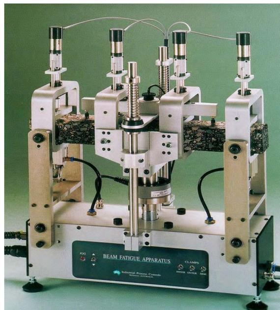
Abbildung 3.17: Darstellung einer möglichen Prüfeinrichtung für den 4-Punkt-Biegeversuch
