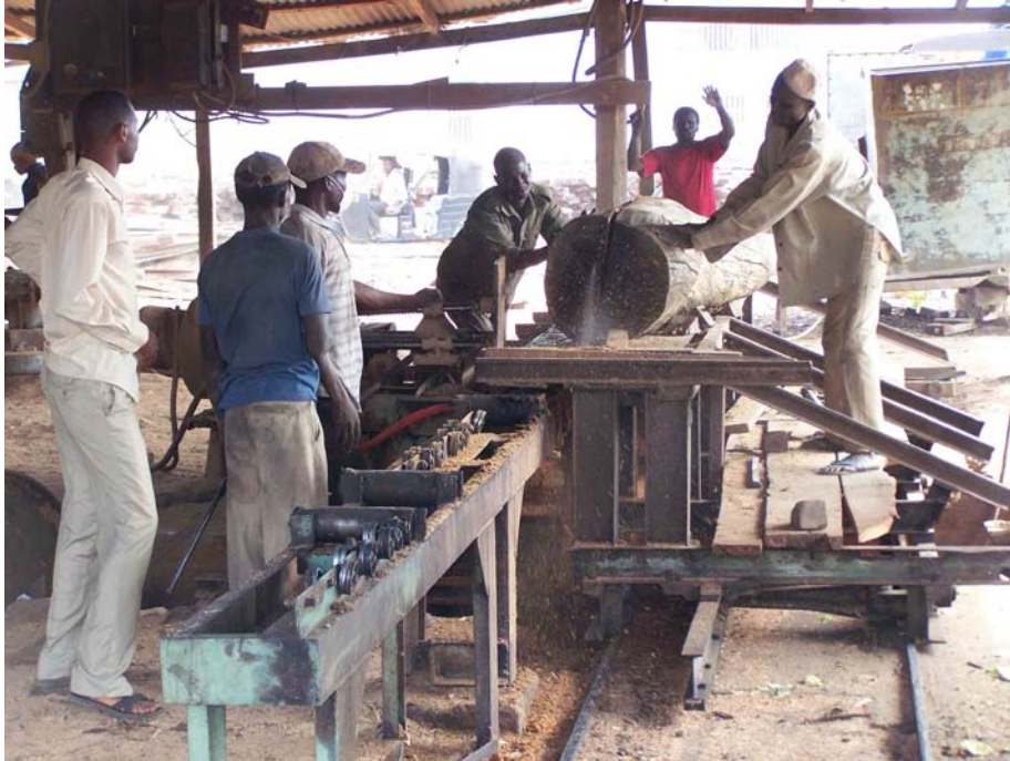
Abb. 8: Einschnitt von Eisenbahnschwellen mittels Kreissäge im Sägewerk Ad-Damazin
